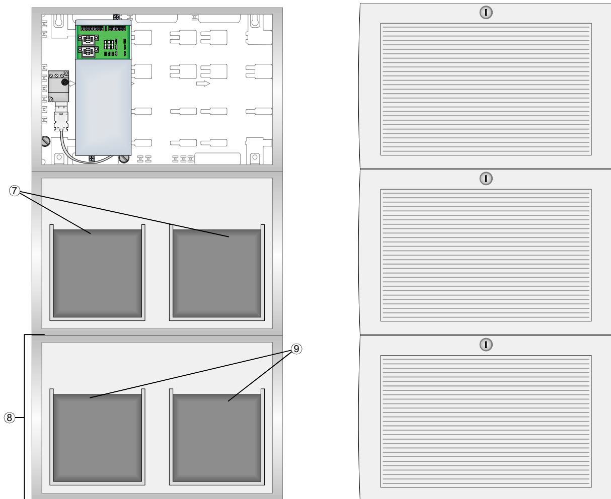
Fig. 14: Strømforingsudvidelse 24 V / 27 Ah (Art. nr. FX808364) inklusiv valgfrie moduler
