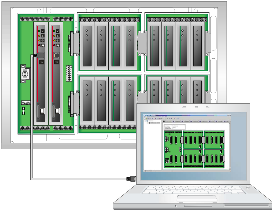
Fig. 3: Service-pc → Central i USB-porten på 1. processormodul
